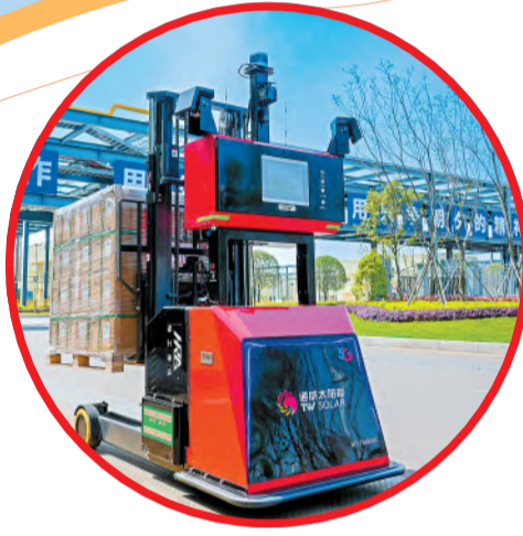
通威太阳能 5G 无人运输叉车
