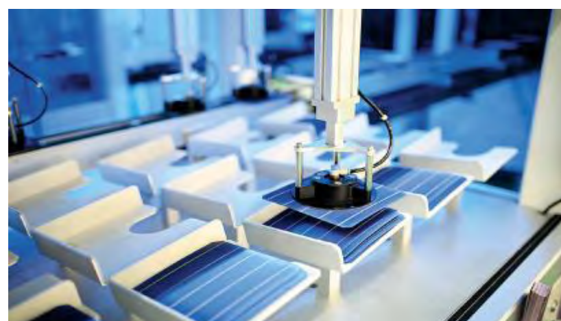
通威太阳能智能制造生产车间成品电池自动分选
