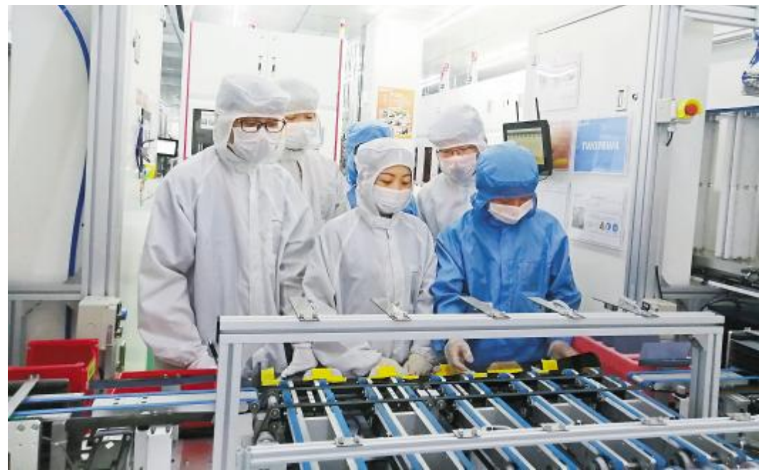
成都公司车间标准化设备保养技改工作现场,员工检查自动化下料皮带
