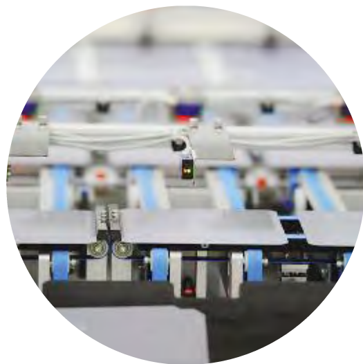
通威太阳能(成都)有限公司 S2 车间刻蚀工段,将扩散的磷硅玻璃去除,对硅片背面进行抛光,提升光电转换效率
