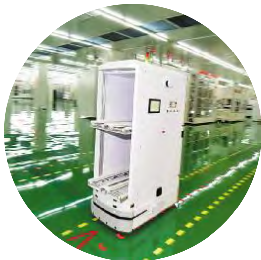
通威太阳能(成都)有限公司 S2 车间自动机器人(IGV)正在将待制品从退火工序送往 PECVD
